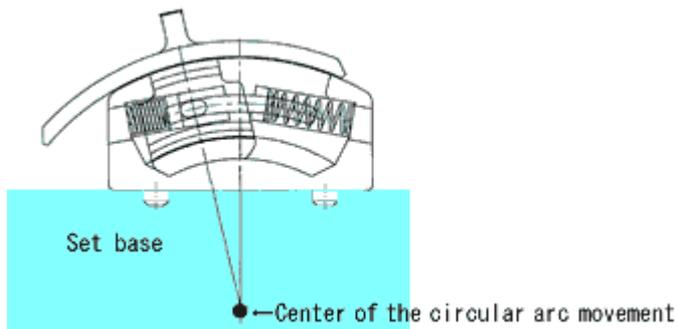
Der Mittelpunkt der kreisförmigen Bogenbewegung befindet sich außerhalb des Schiebeschalters. Die Spiralfeder ermöglicht kompaktere und bessere Designs, da auf die Federarme verzichtet werden kann.
