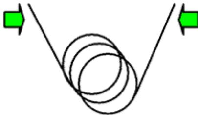
Die Rückstelleinrichtung einer Sprungfeder nutzt die Kräfte der beiden Arme, die versuchen in ihre Ausgangsposition zurückzukehren, sobald sie zusammengedrückt werden. Bei diesem Verfahren müssen jedoch die Feder inklusive der Arme innerhalb eines Bauteils untergebracht werden.
