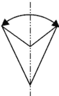
Ein größerer Radius entlang des gleichen Kreisbogens ermöglicht längere Schiebereiche. Größere Radien gestatten trotz kleinerer Bewegungswinkel längere Schiebereiche.
